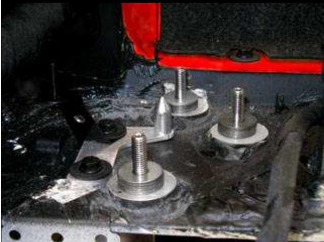
● 检查并确认所安装调节垫片的数量正确。
